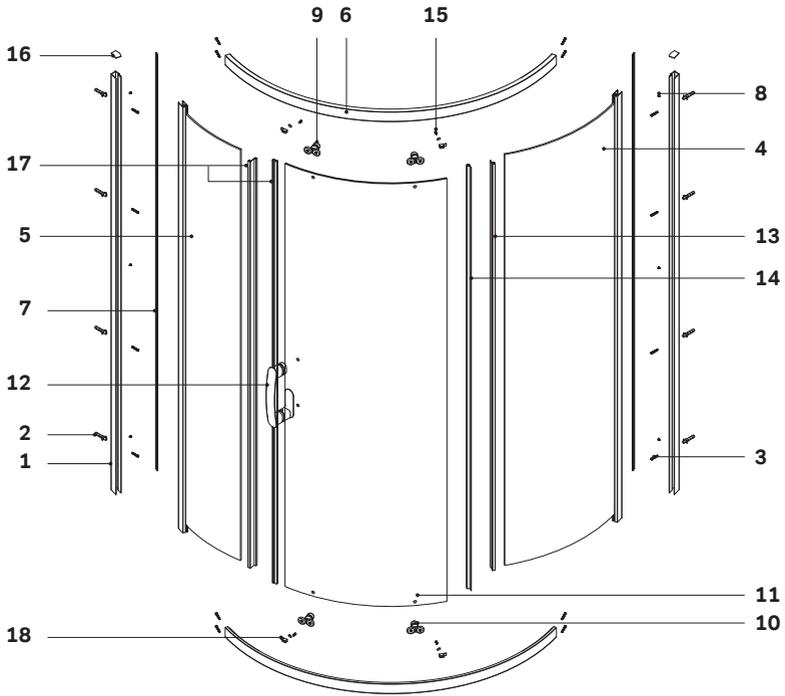
Gehäuse konfiguration / Enclosure configuration / Комплектация ограждения 90x90
