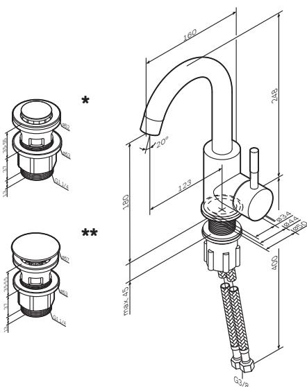
**X-Joy S****F85B027XX****F85B82700\*/XX\*\*****DEU Einhebel-Waschtischarmatur****DNK Håndvaskarmatur****ENG Single-lever basin mixer****FRA Mitigeur monocommande de lavabo****HUN Mosdó csaptelep****ITA Miscelatore lavabo****NOR Servantarmatur****POL Bateria umywalkowa****ROU Baterie lavoar****RUS Смеситель для умывальника****SWE Engrepps tvättställsblandare****UKR Змішувач для умивальника**
